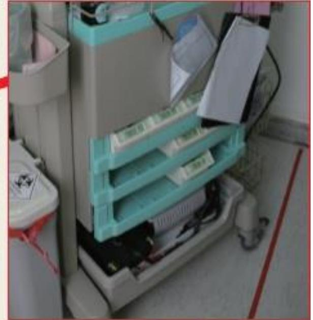
◀臺北醫院改造傳統護理車，外接一臺all-in-one電腦，搭配鍵盤、鎳氫電池、無線傳輸設備等，整臺車增加了10公斤的重量。
